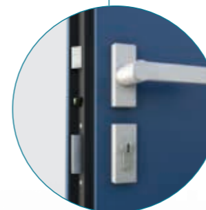
SERRURE À RELEVAGE : ASSURE LA COMPRESSION DES JOINTS D'ÉTANCHÉITÉ SUR LE BÂTI DE LA PORTE.
